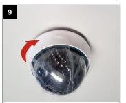
Setzen Sie die Haube wieder auf die Kamera und drehen Sie die Haube in Pfeilrichtung, bis sie einrastet.
