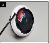
..und drehen Sie gleichzeitig die Anschlussplatte in Pfeilrichtung, um sie zu lösen
