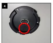
Montieren Sie die Anschlussplatte. Achten Sie auf die Markierung "Camera Front". Richten Sie diese in Blickrichtung der Kamera aus
