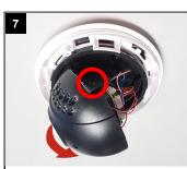
Lockern Sie die Schrauben auf beiden Seiten, und neigen Sie die Blickrichtung auf die gewünschte Position. Ziehen Sie die beiden Schrauben danach wieder feste
