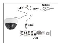
Schließen Sie entweder das Videokabel mit dem gelben oder mit dem grünen BNC-Stecker an ein geeignetes Gerät an (DVR/ Recorder, Monitor).
