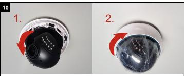
Beim Einrasten verschiebt sich die Blickrichtung ein wenig mit der Drehung. Sie können die Kamera bei Bedarf vorher ein wenig zurückdrehen, damit die Blickrichtung nach dem Einrasten stimmt.
